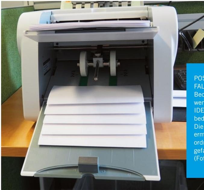
**POSITIV AUFGEFALLEN:** Über das Bedienfeld mit nur wenigen Tasten ist die IDEAL 8306 einfach zu bedienen (Foto rechts). Die Bandauslage ermöglicht eine geordnete Ablage der gefalzten Dokumente (Foto links).
