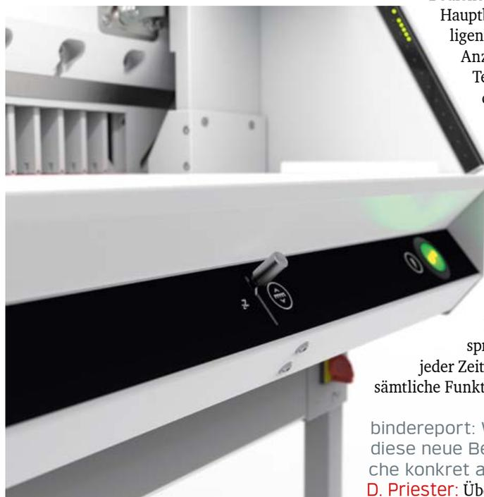
„Precision-Drive“: Dieser „Joystick“ erlaubt die manuelle Feineinstellung des Rückanschlags.
